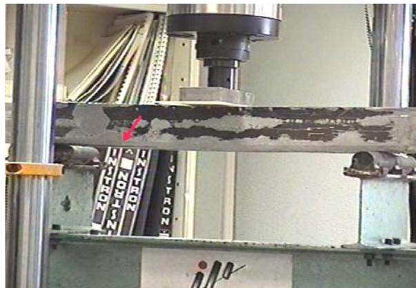
Fig. 14. Viga con refuerzo inferior a flexión, lateral a cortadura (Geometría II)
