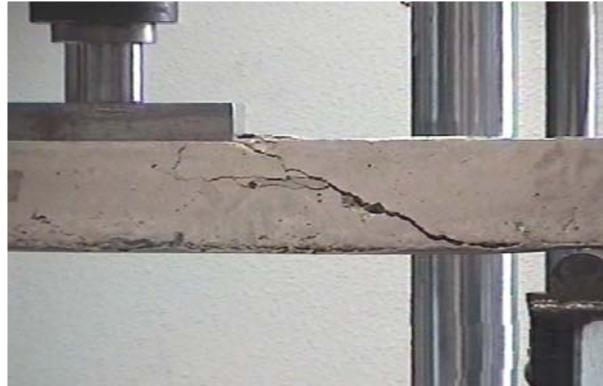
Fig. 12. Viga con refuerzo inferior a flexión (Geometría I)
