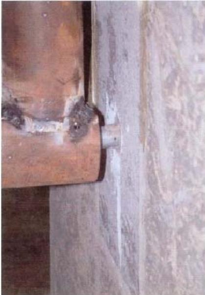
*Pasador de 20mm, a = 25mm, hormigón 35-40 MPa, comienzo de ensayo*
