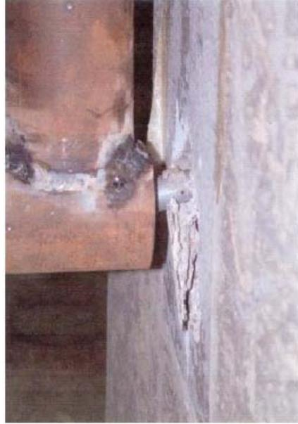
*Pasador de 20mm, a = 25mm, hormigón 35-40 MPa, final de ensayo*
