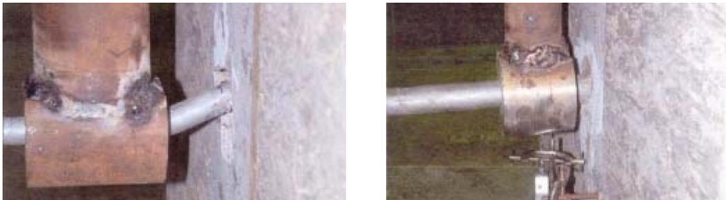
Figura 13: Deformación en pasador de  $\Phi=20\text{mm}$  (izquierda) y  $\Phi=40\text{mm}$  (derecha)
