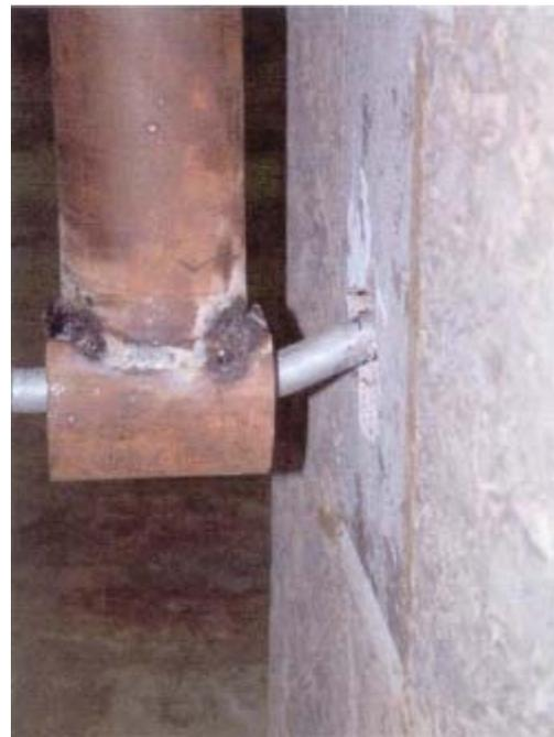
Pasador de 20mm, a = 50mm, hormigón 35-40 MPa, fin de ensayo
